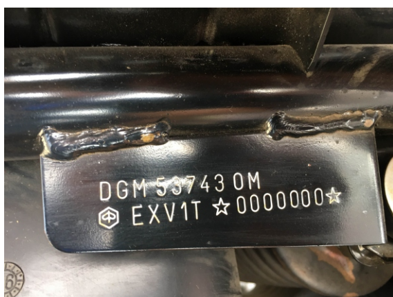
Foto Punzonatura del Numero Telaio
